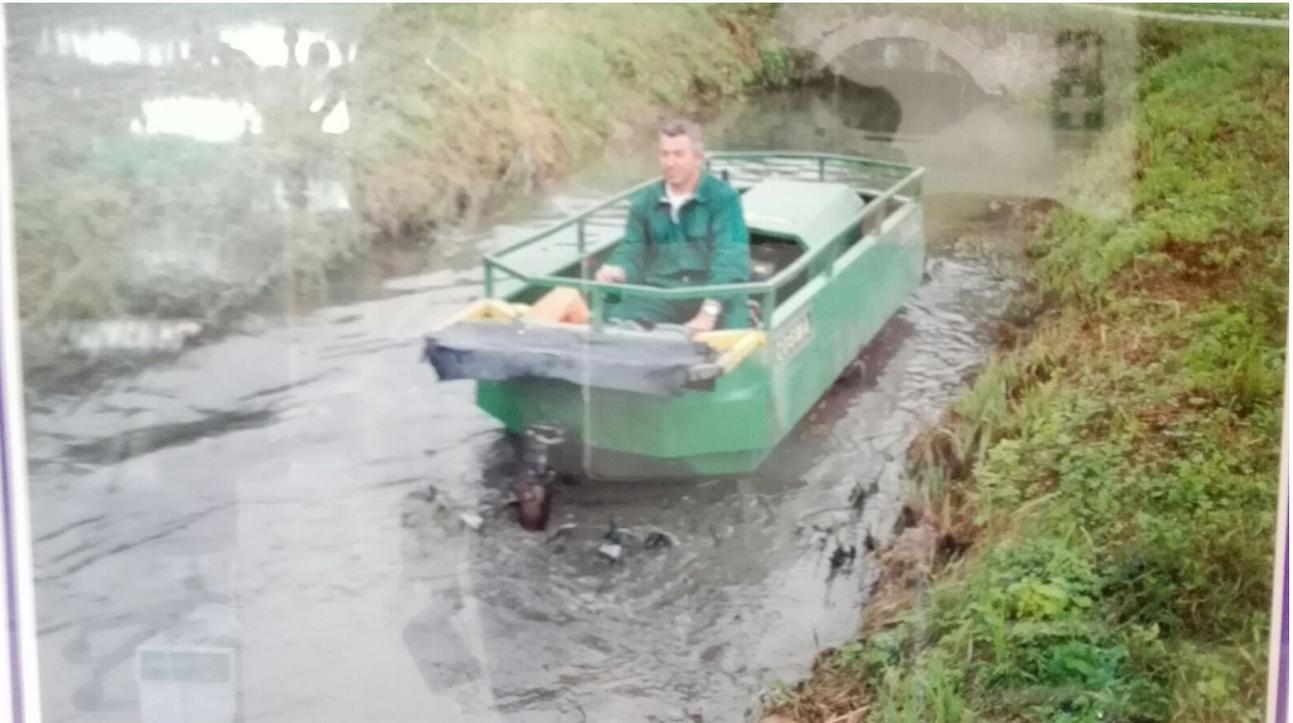
Figura 6: Motobarca utilizzata per gli interventi di manutenzione
