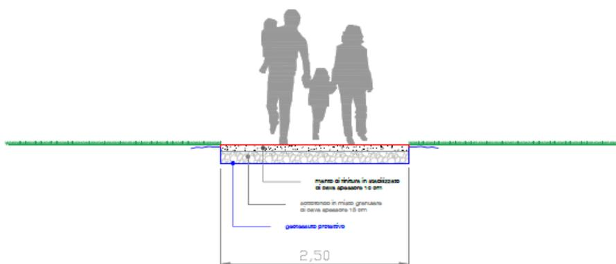
Figura 7: Dettaglio della struttura del percorso pedonale
